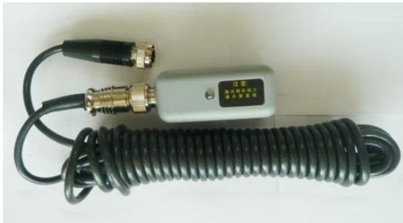
该探头发射激光束到旋转轴上，在旋转轴上的反光标志产生每转一个反射光由该探头转换为 TTL 电信号，用于转速测量、动平衡相位基准和触发采样。
