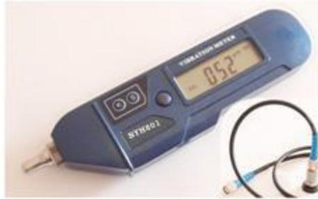
可以选择四种振动测量参数,( 加速度高频包络,加速度, 速度, 位移), 有振动测量、存储, 回放等功能, 使用简便实用, 可以连接计算机, 回放存储的数据及波形进行趋势分析和波形分析等, 在测量现场数采器可以翻看 50 个存储点的任意一点的振值。适用于机械设备(由轴系旋转和结构问题引起的, 如不平衡、轴不对中、松动)等问题的诊断及故障分析。
