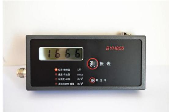
BYH806 测振表是一种超小型的振动测量仪器，它可以测量振动位移、速度、加速度和高频加速度的有效值、峰峰值和峰值。BYH806 可用于各种机电产品的质量检验和通用振动测量,是设备状态监测的理想工具。
