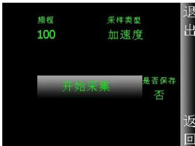
长波形页面会先转入设置页面，设置一种采样类型【加速度、速度、位移、包络】再选择是否保存【默认是不保存】，然后点开始采集，进入长波形采集状态
