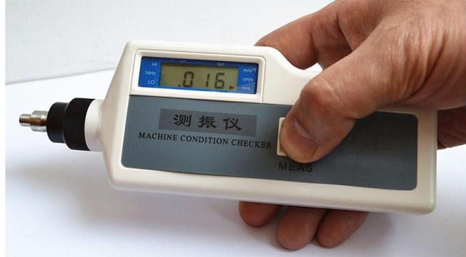
BYH806C 测振表是一种超小型的振动测量仪器，它可以测量振动位移、速度、加速度和高频加速度的有效值、峰峰值和峰值；可用于各种机电产品的质量检验和通用振动测量，是设备状态监测的理想工具。
